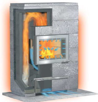
Een massieve speksteenkachel waarvan één van beide korte tegenstroomkanalen zichtbaar is gemaakt.
